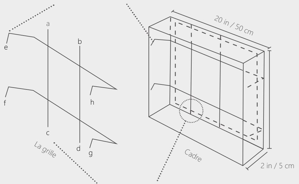
Les dents a, b, c et d vont derrière le dos du cadre pour sécuriser le support de fil pendant la dépose du filtre chargé
