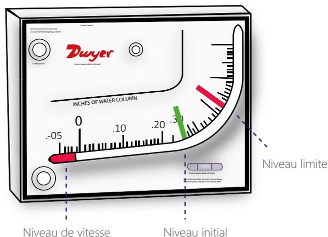
La perte de charge maximale recommandée pour un filtre Andreae est de 128 Pa (0,51 in wc). Cependant, un filtre Andreae peut supporter une chute de pression maximale allant jusqu'à 1,03 in wc, si le ventilateur en est capable. Andreae Filters encourage (et met en garde) les finisseurs à essayer d'atteindre la pression la plus élevée possible pour obtenir la durée de vie maximale des filtres.
